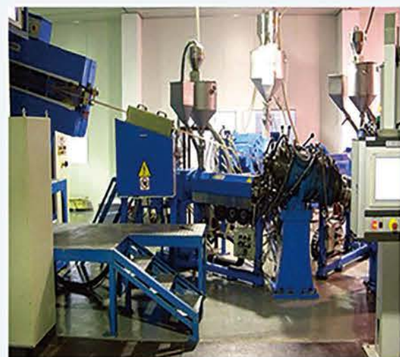
35kV干法交联三层共挤设备
