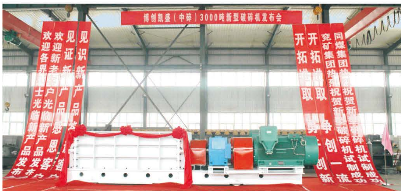
同煤集团3000t/h中碎破碎机发布会(入料粒度 \leq 300\text{mm} , 出料粒度 \leq 50\text{mm} )
