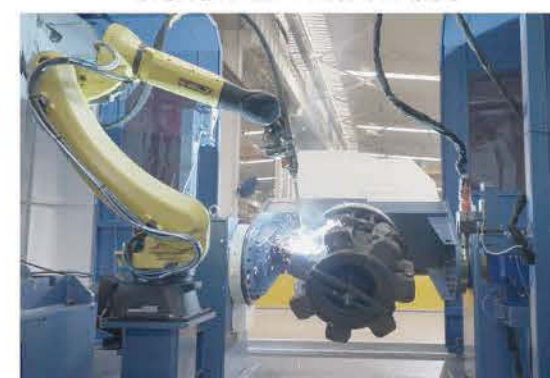
专用焊接机器人-链轮堆焊修复
