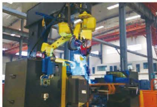
中部槽焊接机器人-中部槽焊接
