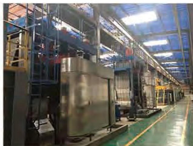
BLZG40m²和BLZG25m²立式压滤机使用现场(氧化锌)
