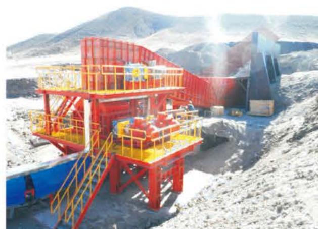
蒙古国胡硕图露天矿1000t/h破碎站
