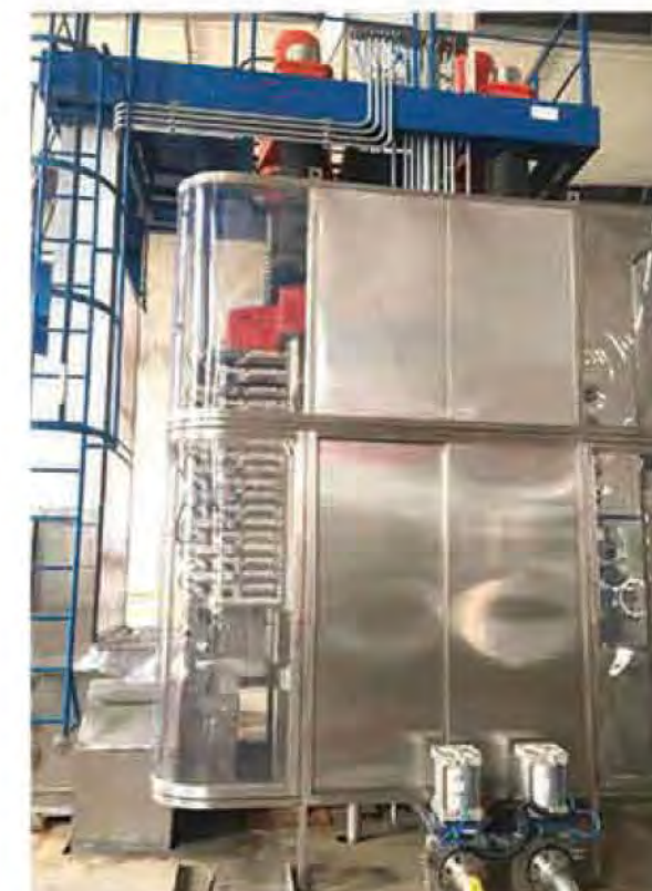
BLZG45m²立式压滤机现场(磷酸铁)
