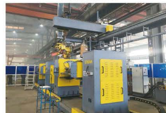
中部槽焊接工作站
