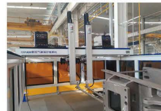
中部槽专用熔覆焊机-中部槽耐磨堆焊
